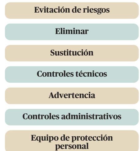
Figura 2. Jerarquía de controles. Fuente: Adaptado de ANSI/ASSE Z590.3-2011, p. 24, by ANSI/ASSE, 2011, Des Plaines, IL: Autor
